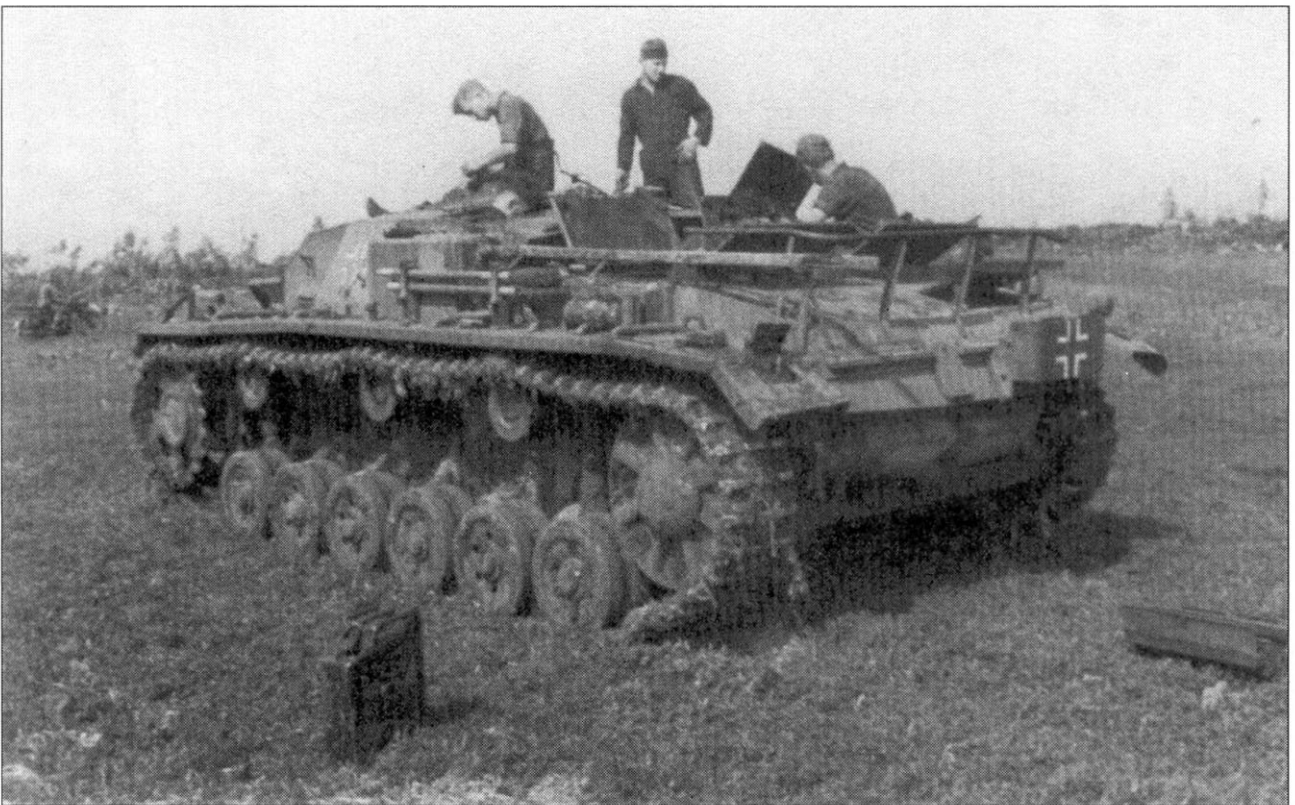
Вид сзади на штурмовое орудие модели Ausf. B. Судя по ведущим колесам нового типа и наличию бронеклопа дымопускowego устройства, эта машина - позднего выпуска. На корме укреплен рама для перевозки имущества экипажа. Обратите внимание на стоящую на переднем плане немецкую бензиновую канистру - такие же изделия и сейчас сильно распространены на территории бывшего Советского Союза.
