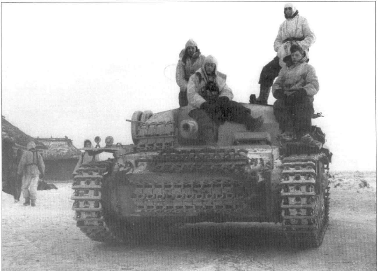
StuG III Ausf. E из 202-го батальона штурмовых орудий сфотографирована на Восточном фронте, декабрь 1942 г. Машины этого батальона имели собственные имена, например: «Леопард», «Аллигатор», «Ягуар». Ко второй зиме в России вермахт успел подготовиться - танкисты одеты в специальную зимнюю униформу. Машина увешана гусеничными траками, передние секции надгусеничных полок отсутствуют, наклонная лобовая броня рубки залита бетоном, поэтому имеет покатый скат.
