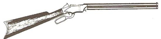
**Volcanic; carabina #3 (1855) 5%**; Carabina americana de cartuchos (rocketbullet), de acción mediante palanca y treinta disparos. Calibre .394, 100 cm de longitud y 2,6 kg de peso. Esta carabina de repetición se armaba usando la guarda del gatillo. La recámara era un tubo situado bajo el cañón.
