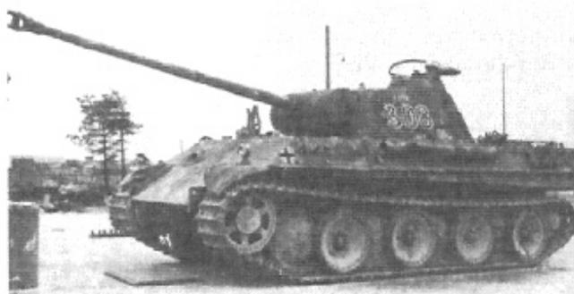
**Panzer V "Panther":** Desarrollado como oponente al eficaz T-34 soviético. Las planchas inclinadas de su coraza le dotaban de una excelente protección. Tenía una aceptable velocidad y una buena suspensión. Los primeros modelos, debido a una producción precipitada, sufrieron muchas averías, mejoradas posteriormente. Alcanzó la cifra de 6.000 ejemplares y su chasis fue usado para los autopropulsados Jagdpanther y los carros de socorro Bergepanther.
